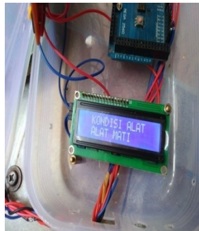
Gambar 4.6.2 LCD menunjukkan kondisi alat
