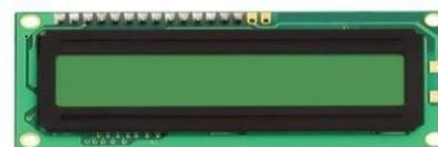
Gambar 4. Lcd 16 x 2
