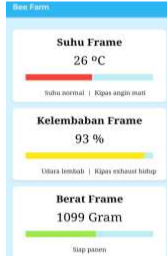
Gambar 12. Tampilan sensor Load cell untuk mendeteksi berat layak panen
