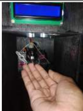
Gambar 4.5 Cairan hand sanitizer berhasil keluar secara otomatis
