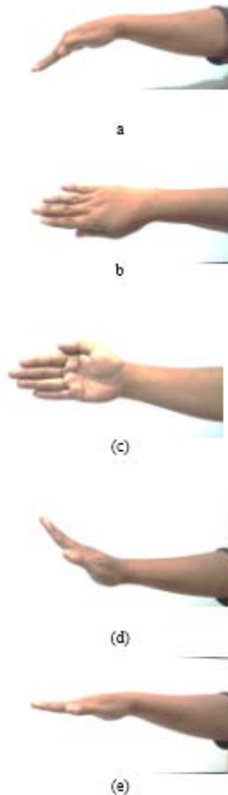
Gambar 8. (a) Instruksi maju, (b) instruksi belok kanan, (c) instruksi belok kiri, (d) instruksi mundur, dan (e) Instruksi berhenti
