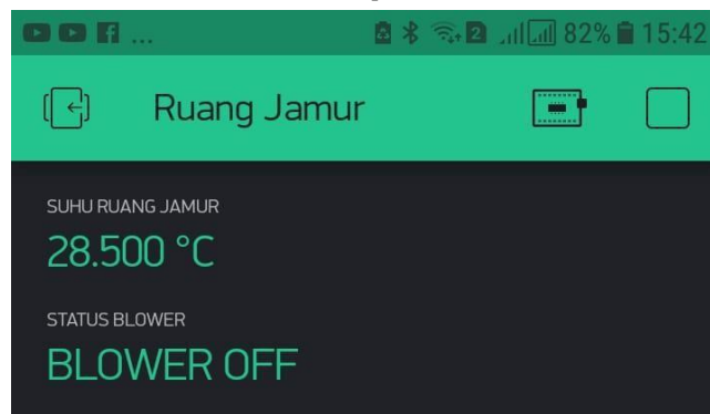
Gambar 3.17 Desain Antarmuka Monitoring Ruang Jamur pada Blynk
