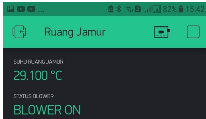
Gambar 3.19 Pengujian pada saat suhu ruang jamur lebih lebih besar sama dengan 29 Derajat Celcius
