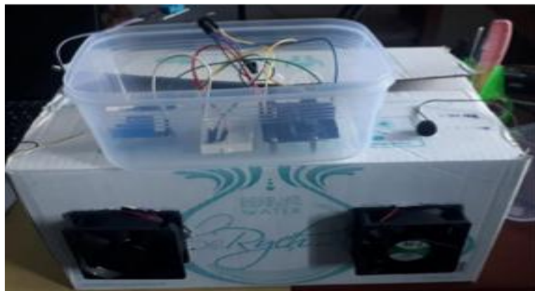
Gambar 3.15 Prototipe Konstruksi Sederhana Sistem Monitoring Ruang Jamur
