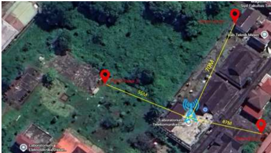
Gambar 5. Peta Lokasi Pengujian dan Jarak Komunikasi Lora Antara Tiga Transmitter Panel Surya dan Satu Receiver.
