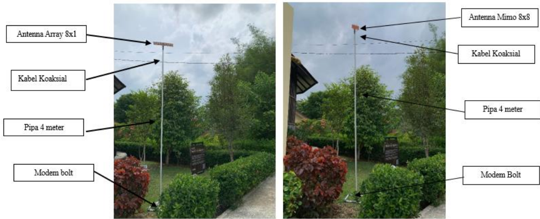
Gambar 13. Pengujian kedua antena (MIMO dan Array 8x1) Pada Lokasi Kebun Raya Balikpapan
