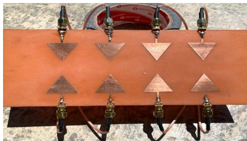
Gambar 11. Fabrikasi antena MIMO
