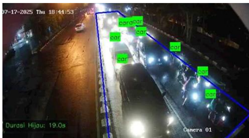
Gambar 4.3 Deteksi kendaraan pada malam hari dengan YOLO
