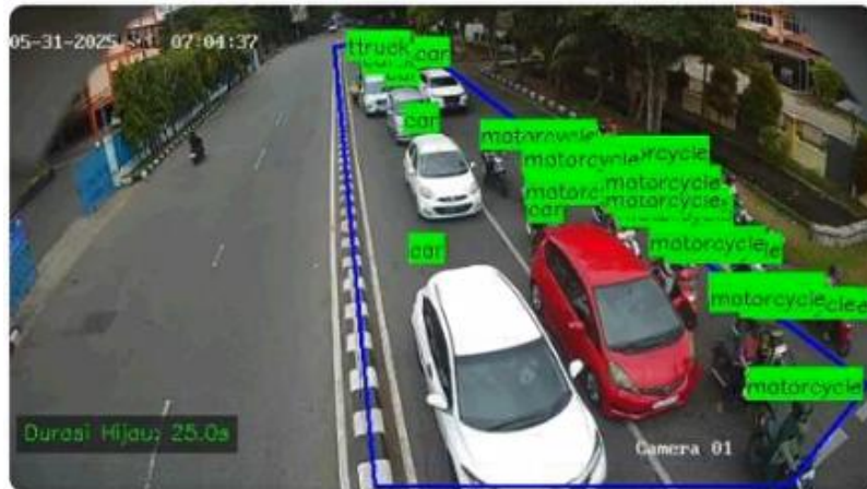
Gambar 3.1 Deteksi kendaraan pada siang hari dengan YOLO
