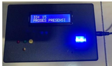
Gambar 15. Pengujian Sensor Sidik Jari Terdaftar
