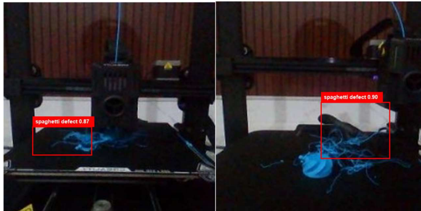
Gambar 6. Hasil deteksi spaghetti defect dengan bounding box dan confidence score
