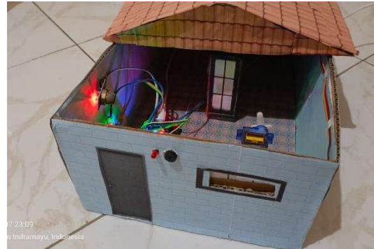
Gambar 2. prototype ruang server tampak atas
