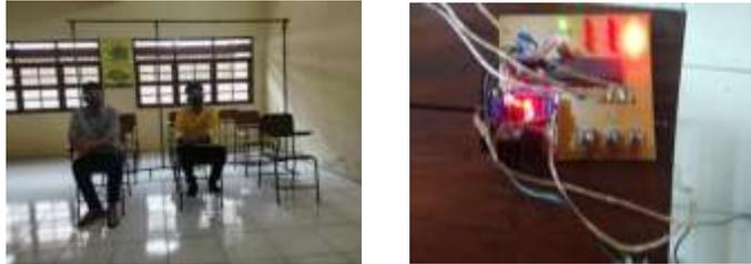
Gambar 20. Tahap ke-1 sensor PIR mendeteksi keberadaan manusia pada tempat duduk A1,A2,A3
