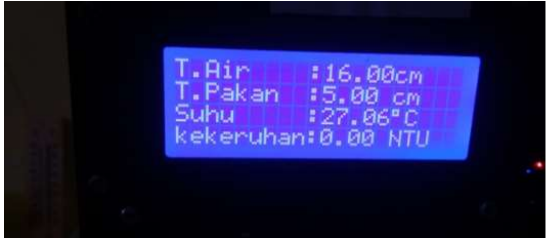
Gambar 8. Hasil Pengujian LCD (Hasil Pembacaan Sensor)
