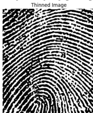
Gambar 8. Hasil dari melakukan Thinning menggunakan algoritma Guo-Hall menggunakan regina2.jpg
