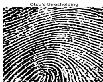
Gambar 7. Hasil dari melakukan Otsu Thresholding menggunakan regina2.jpg
